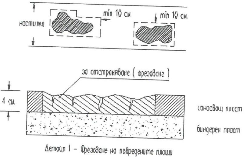
Преди започване на фрезоването в определен участък, за него се изготвя технологичен проект, който съдържа точните координати на съществуващото положение в оста и краищата на пътя през 10 метра и проектните координати на същите подробни точки.
